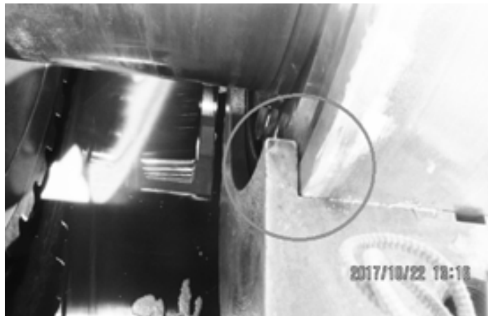
شکل ۸- صفر کردن فاصله‌ی بوش با پوسته‌ی گیربکس
