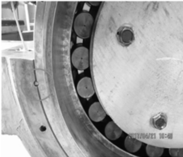
شکل ۷- تنظیم BACKLASH با بوش قفل کردن آن
